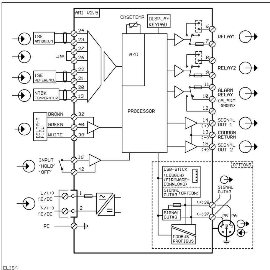
Сигнализация о неисправности анализатора и превышении измеренными значениями программируемых уставок.
